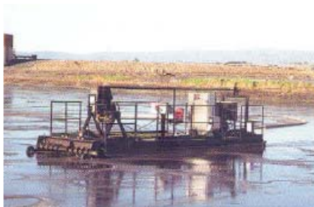
Slika 7. Hidraulički način vađenja plivajućeg sloja ugljikovodika pumpom na splavi
