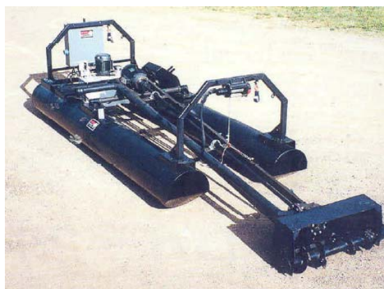
Slika 7. Hidraulički način vađenja plivajućeg sloja ugljikovodika pumpom na splavi
