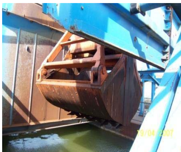
Slika 9. Princip plivajućeg jaružala za mehaničko vađenje krutog otpada
